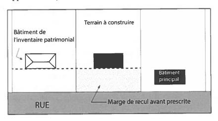
En cas d'impossibilité de respecter les normes d'alignement prescrites, la construction sera possible dans la mesure où le bâtiment respecte les normes d'implantation prescrites à la grille de spécifications. Dans tous les cas, un écart de 30 centimètres par rapport à la norme d'alignement est jugé acceptable à la suite des travaux.
